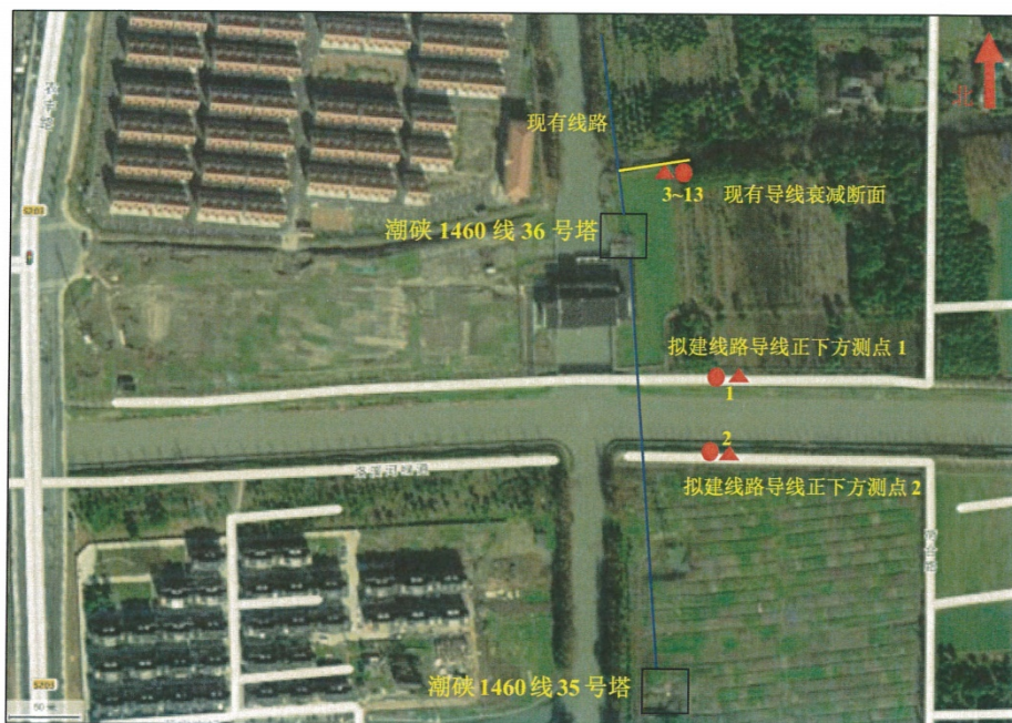
图 1、110kV 潮硤 1460 线#36-#37 改迁工程工频电磁场及噪声监测点位示意图 (此页以下空白)
