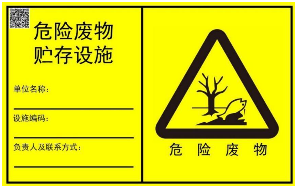
图 4-6 危废仓库室外危险废物标签
