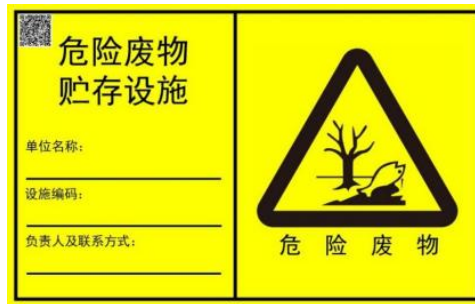
图 4-6 危废仓库室外危险废物标签
